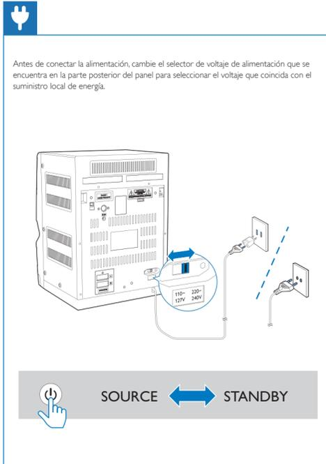
Antes de conectar la alimentación, cambie el selector de voltaje de alimentación que se encuentra en la parte posterior del panel para seleccionar el voltaje que coincida con el suministro local de energía.
