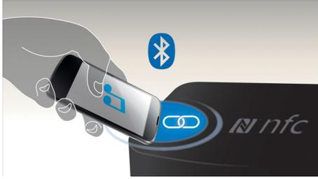
Emparelhe dispositivos Bluetooth facilmente com a tecnologia NFC (Near Field Communications, Comunicações de campo próximo) de um toque. Toque o smartphone ou tablet habilitado para NFC na área de NFC de uma caixa acústica para ligar a caixa, comece o emparelhamento via Bluetooth e inicie a transferência de músicas.
