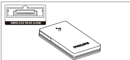
**2** Подключите тыловые АС к беспроводному приемному устройству.
