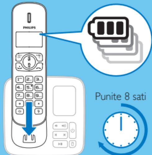
Postavite telefon na baznu stanicu da se napuni. Kada slušalicu ispravno stavite na baznu stanicu, čuće se zvučni signal.
