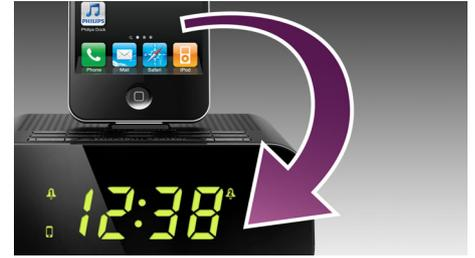
Cuando conectas tu iPod o iPhone a la base, el reloj se sincroniza automáticamente en pocos segundos. Con esta práctica función, ya no necesitas configurar la hora manualmente.
