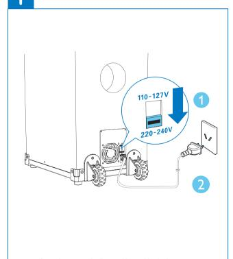
Antes de conectar la alimentación, cambie el selector de voltaje de alimentación que se encuentra en la parte posterior del panel para seleccionar el voltaje que coincida con el suministro local de energía.
