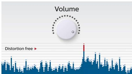
抗削顶尖失真功能让您可以大声播放音乐并保持优质音效，即使是在电池电量不足时。该功能可接受 300 毫伏至 1000 毫伏等一系列输入信号，让您的扬声器丝毫不受失真的影响。该内置功能可监控通过放大器的
