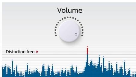
抗削顶尖失真功能让您可以大声播放音乐并保持优质音效，即使是在电池电量不足时。该功能可接受 300 毫伏至 1000 毫伏等一系列输入信号，让您的扬声器丝毫不受失真的影响。这款扬声器通过专用音效限制器 IC 处理抗削顶尖失真。该监控通过放大器的音乐信号，将信号峰值控制在放大器的范围内，防止由削顶造成的音频失真，而丝毫不影响响度。便携式扬声器再现音乐峰值的能力会随着电池电量的下降而降低，而抗削顶尖失真功能却能减少因电池电量不足导致的峰值下降。
