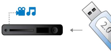
Die universelle serielle Schnittstelle, kurz USB genannt, ist ein Standardprotokoll für den problemlosen Anschluss von PCs, Peripheriegeräten und Unterhaltungselektronik. High-Speed USB-Geräte haben eine Datenübertragungsrate von bis zu 480 Mbit/s, im Gegensatz zu den 12 Mbit/s des ursprünglichen USB-Standards. Mit der High-Speed USB 2.0-Verbindung müssen Sie lediglich Ihr USB-Gerät anschließen, den Film, den Musiktitel oder das Foto auswählen und die Wiedergabe starten.
