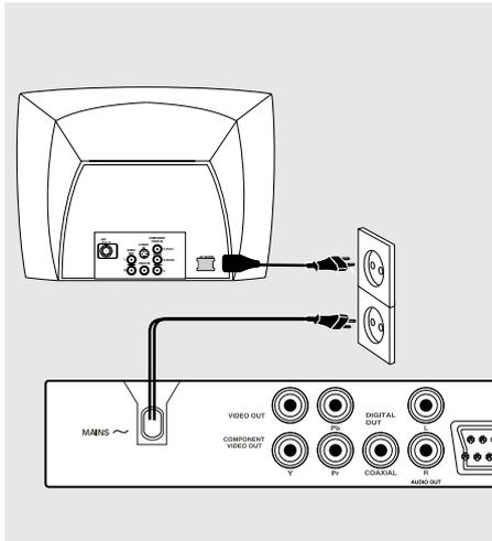
**Después de que todo esté conectado correctamente, enchufe el cable de alimentación de CA en el tomacorriente.** No realice ni cambie nunca conexiones con la corriente conectada.
