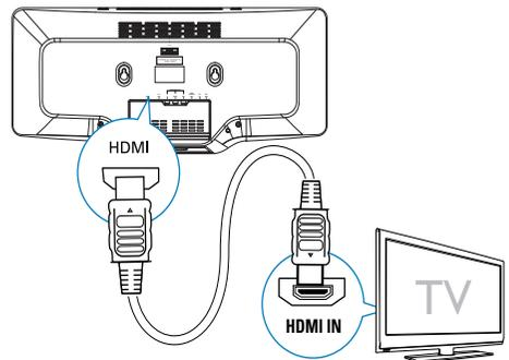
Em TVs compatíveis com HDMI (High Definition Multimedia Interface), DVI (Digital Visual Interface) ou HDCP (High-bandwidth Digital Contents Protection) conecte a saída do micro theater à entrada HDMI da TV para obter a melhor qualidade de imagem.
