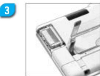
3 Mettez l'adaptateur LAN sans fil dans la position correcte jusqu'à ce qu'il soit parfaitement emboîté et remplacez le couvercle.
