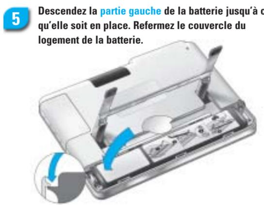
5 Descendez la partie gauche de la batterie jusqu'à ce qu'elle soit en place. Refermez le couvercle du logement de la batterie.
