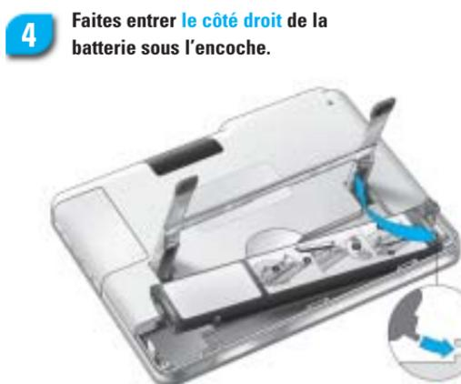
4 Faites entrer le côté droit de la batterie sous l'encoche.
