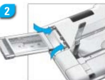
2 Insérez l'adaptateur LAN sans fil dans le logement.
