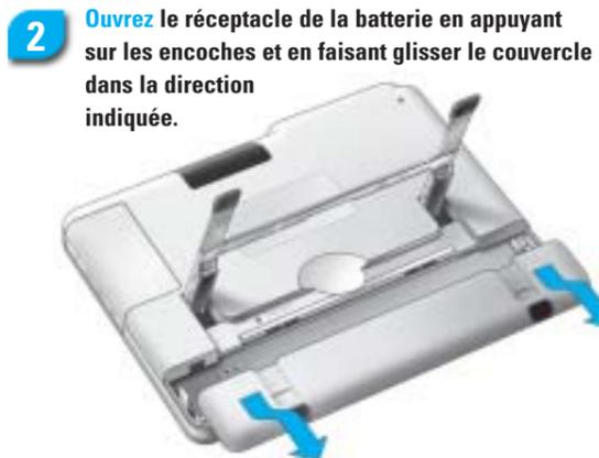
2 Ouvrez le réceptacle de la batterie en appuyant sur les encoches et en faisant glisser le couvercle dans la direction indiquée.
