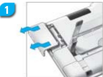
1 Ouvrez le réceptacle de l'adaptateur LAN sans fil en appuyant sur les encoches et en faisant glisser le couvercle dans la direction indiquée.
