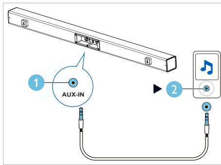
1 باستخدام كابل صوت استريو 3.5 مم، صل وصلة **LINE IN** الموجدة بالعارض الصوتية بوصلة **LINE OUT** الموجودة بالتلفاز أو جهاز آخر.
