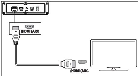
1 باستخدام كابل HDMI على السرعة، صل وصلة **(TV) - HDMI OUT (ARC)** الموجدة بالعارضة الصوتية بوصلة **HDMI ARC** الموجودة في التلفاز.
