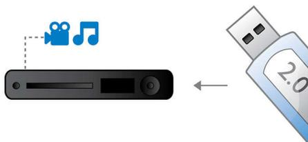
Универсальная последовательная шина, или USB - это стандартный протокол для удобной связи компьютеров, периферийных устройств и электронного оборудования клиента. Устройства Hi-Speed USB обеспечивают высокоскоростной перенос данных до 480 Мбит/с - по сравнению с 12 Мбит/с для обычных USB. Благодаря соединению Hi-
