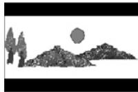
– **4:3 Panscan** falls Sie ein normales Fernsehgerät haben und Teile des Bildes links und rechts beschnitten werden sollen,
