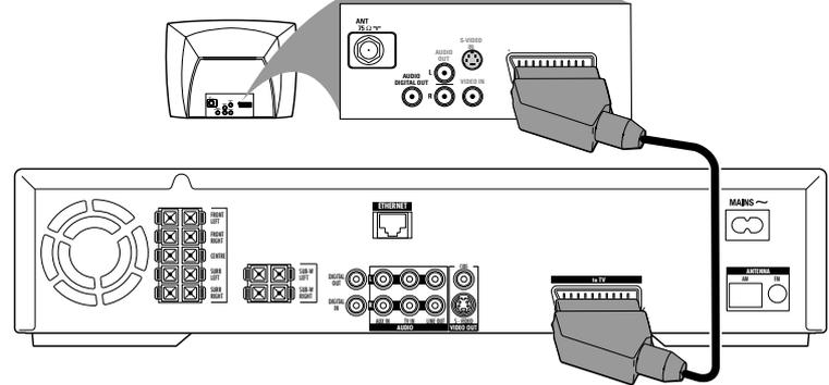
Verbinden Sie die Scartbuchse an Ihrem Fernsehgerät und die Scartbuchse (**to TV**) am Streamium-System mit dem mitgelieferten Scartkabel. Falls Ihr Fernsehgerät keine Scartbuchse hat, lesen Sie bitte Seite 12 der Bedienungsanleitung.
