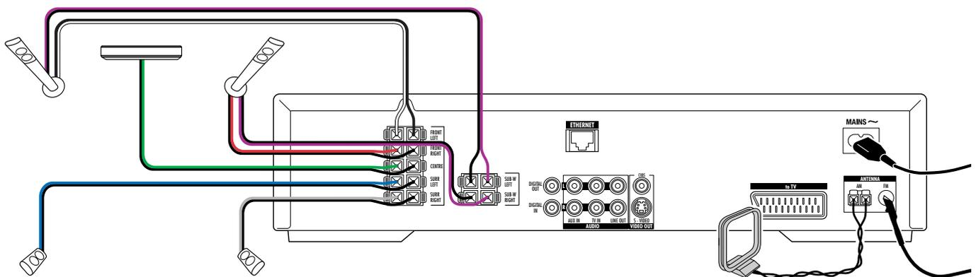
**5** Verbinden Sie Lautsprecherkabel mit dem Streamium-System.
