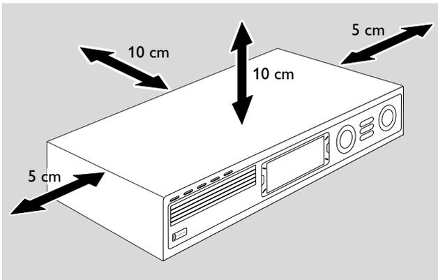
Bedecken Sie nicht die Lüftungsschlitze.
