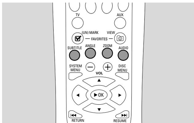
Die Funktionsweise der farbigen Multifunktionstasten auf der Fernbedienung (SUBTITLE, ANGLE, ZOOM und AUDIO) und der 2 Multifunktionstasten am Streamium-System hängt von der Art des Mediums ab, das Sie spielen. Am Fernsehschirm wird angezeigt, welche Tasten eine besondere Funktion haben.
