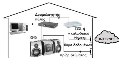
Αφού έχετε επιβεβαιώσει ότι λειτουργεί η σύνδεση στο διαδίκτυο ενός υπολογιστή του οικιακού δικτύου, συνδέστε το MC-i250 στο δρομολογητή πύλης με το παρεχόμενο καλώδιο. Πατήστε το INTERNET.
