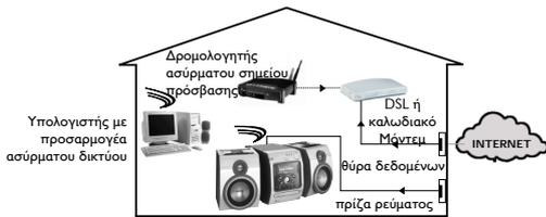
**1** Εάν κατά την αρχική ρύθμιση δεν έχει συνδεθεί στη συσκευή κάποιο καλώδιο δικτύου, θα σας ζητηθεί εάν θέλετε ενσύρματη (Ethernet) ή ασύρματη (WiFi) λειτουργία. Επιλέξτε ασύρματη λειτουργία. Για οποιαδήποτε επιπλέον σύνδεση, η συσκευή θα εκκινήσει στον τρόπο λειτουργίας που χρησιμοποιήθηκε την τελευταία φορά. Μπορείτε να αλλάξετε αυτή τη ρύθμιση οποιαδήποτε άλλη στιγμή, από το μενού 'SET OPTIONS' (Ρυθμίσεις συσκευής) του στοιχείου 'SELECT NETWORK' (Επιλογή δικτύου).
