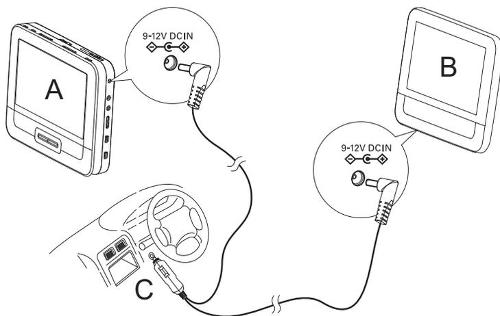
**A:** основное устройство; **B:** второй экран; **C:** прикуриватель автомобиля
