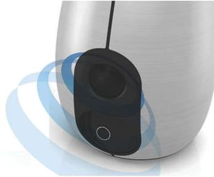
La charge acoustique Bass Reflex utilise un évent de basses adapté au volume acoustique de l'enceinte afin de reproduire des basses profondes avec une enceinte compacte. L'évent de basses soigneusement conçu et profilé facilite le passage de l'air et permet d'obtenir des basses profondes et puissantes, même lorsque le volume est élevé, tout en réduisant les turbulences d'air, sources de distorsion.
