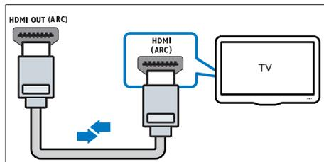
1 Utilisez un câble HDMI haute vitesse pour relier le connecteur **HDMI OUT (ARC)-TO TV** de votre barre de son au connecteur **HDMI ARC** de votre téléviseur.
