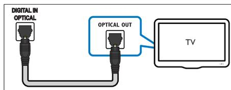
1 À l'aide d'un câble optique, reliez le connecteur **OPTICAL** de votre barre de son au connecteur **OPTICAL OUT** de votre téléviseur ou d'un autre appareil.
