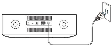
将交流电源线连接至电源插座。
