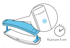
È possibile caricare il ricevitore ponendolo sulla base docking, nella direzione che si preferisce. Il LED sulla parte posteriore del ricevitore lampeggia una volta.
