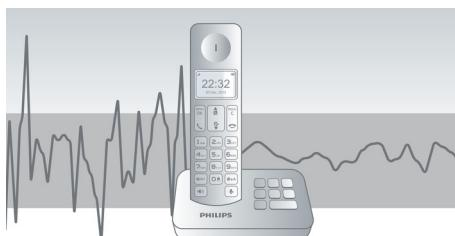
Le contrôle automatique de volume élimine les variations de signal sonore causées par la distance, la puissance du signal ou le téléphone de l'appelant, pour un volume sonore constant. Il réduit l'amplification sonore pour les signaux puissants et l'augmente pour les signaux faibles afin de vous permettre de discuter au téléphone sans subir de variations de volume désagréables.
