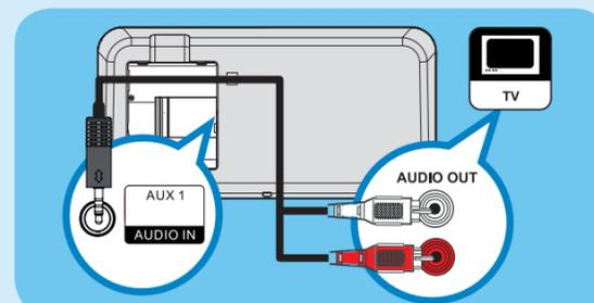
**Σημείωση** Για έξοδο ήχου από αυτή τη σύνδεση, πατήστε επανειλημμένα **AUX/DI /MP3 LINK** μέχρι στην οθόνη ενδείξεων να εμφανιστεί η ένδειξη 'AUX1 INPUT'.
