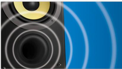
El sistema de altavoces Bass Reflex ofrece unos graves profundos con altavoces de reducidas dimensiones. Se distingue de los sistemas convencionales en que se ha añadido un túnel de graves alineado acústicamente con el woofer, que optimiza el límite de baja frecuencia del sistema. El resultado son unos graves mejor controlados, más profundos y con menor distorsión. El sistema hace
