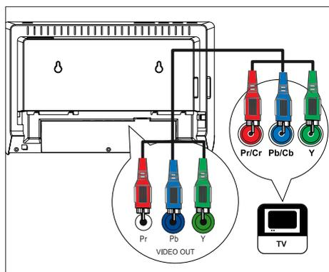
1 Utilice los cables de vídeo por componentes (no incluidos) para conectar las tomas **Y Pb Pr** de esta unidad a las tomas de entrada de vídeo por componentes del televisor.
