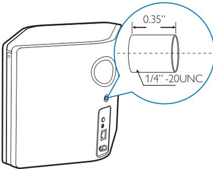
Celui-ci vous permet de monter facilement l'appareil sur le mur avec un support de montage approprié. Le support de montage n'est pas inclus. Vous devez en acheter un. Veuillez suivre les instructions fournies avec le support de montage mural que vous avez acheté.
