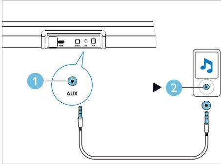
1 باستخدام كابل صوت استريو مقاس 3.5 مم، صل وصلة **AUX** بالعارضة الصوتية بوصلة **AUX** بالتلفاز أو أي جهاز آخر.
