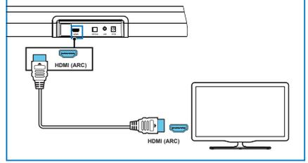
1 باستخدام كابل HDMI، صل وصلة HDMI على العارضة الصوتية بـ **HDMI OUT** أو جهاز آخر.
