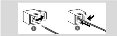
Conecte los terminales a SPEAKERS, el altavoz derecho a "RIGHT" y el altavoz izquierdo a "LEFT". El alambre de color (marcado) a "+" y el negro (no marcado) a "-". Inserte completamente la parte pelada del hilo del altavoz en el terminal, de la forma mostrada.
