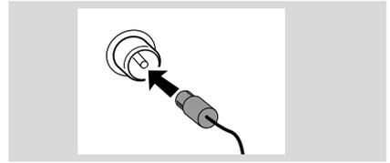
No es necesario conectar el cable de antena para FM porque está incorporado al sistema.
