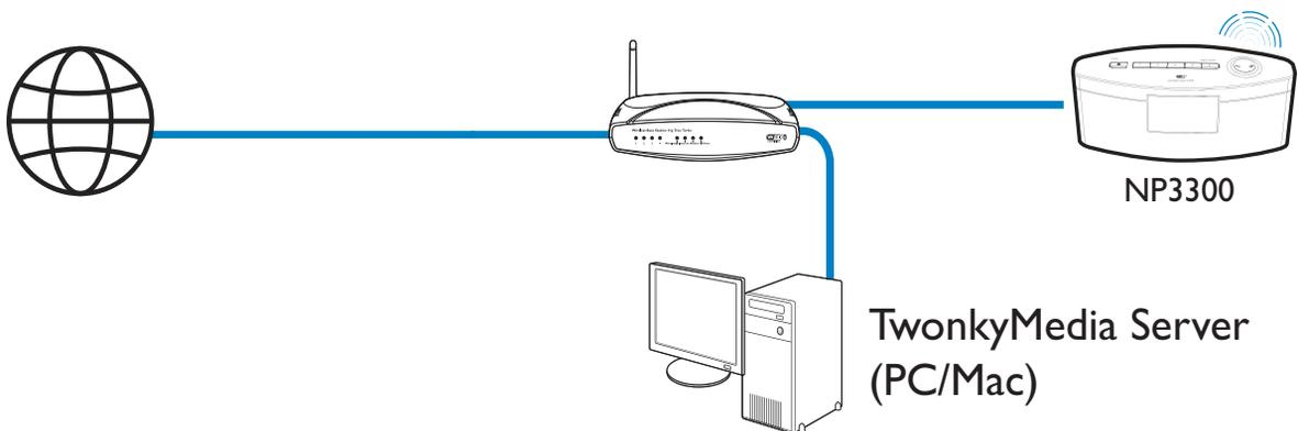
Puede conectar el **NP3300** a una red Wi-Fi/con cables doméstica de varias formas: de forma inalámbrica o con cables, automática o manual.
