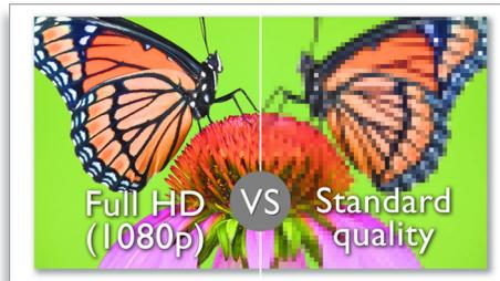
Записывайте видео в высоком разрешении и просматривайте их в том же качестве (full HD 1080p). "1080" означает разрешение изображения (количество горизонтальных линий на экране); "P" обозначает прогрессивную развертку, или
