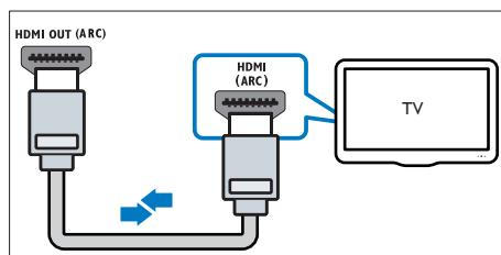
**1** Kabelem vysokorychlostního rozhraní HDMI propojte výstupní konektor **HDMI OUT (ARC)** domácího kina s konektorem **HDMI ARC** televizoru.
