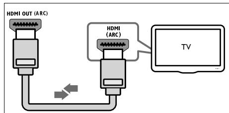
**1** С помощью высокоскоростного кабеля HDMI подключите разъем **HDMI OUT (ARC)** домашнего кинотеатра к разъему **HDMI ARC** телевизора.
