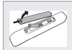
*Poznámka: Ak indikátor po každom stlačení štyrikrát zabliká, diaľkový ovládač signalizuje, že batérie sú skoro vybité. Vymeňte staré batérie za nové, typu AAA.*
