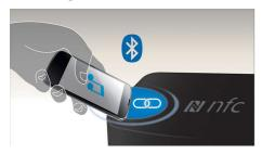
Couplez aisément des appareils Bluetooth® grâce à la technologie NFC (Near Field Communications). Il vous suffit d'approcher le smartphone ou la tablette compatible NFC de la zone NFC d'une enceinte pour allumer celleci, activer le couplage Bluetooth® et commencer à diffuser de la musique.
