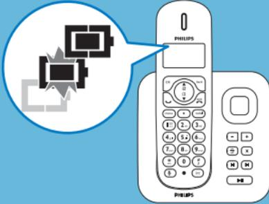
El cihazı baz istasyonunda/şarj cihazında değilken, simge pil seviyesini gösterir:
