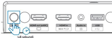
→ Dok zvučnik na proizvede drugi ton, a potom otpustite dugme.
