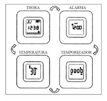
Gire el reloj en el sentido de las agujas del reloj para apoyarlo sobre cada uno de sus lados y ajustar las siguientes funciones:
