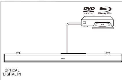
Verwenden Sie ein optisches Kabel, um **OPTICAL** Ihrer Soundbar an **OPTICAL OUT** am Fernseher oder einem anderen Gerät anzuschließen.
