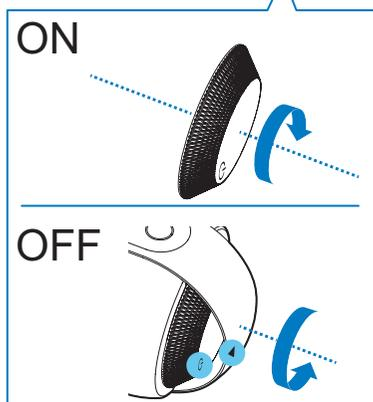
Чтобы включить или выключить АС, поверните регулятор по или против часовой стрелки до щелчка.
