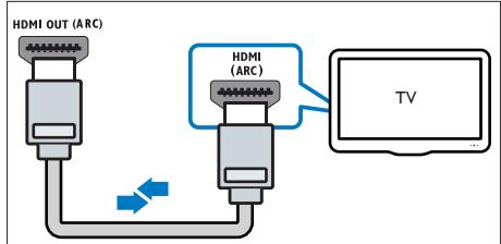
1 使用高速 HDMI 纜線，連接家庭劇院的 **HDMI ARC** 接頭和電視的 **HDMI OUT (ARC)** 接頭。
