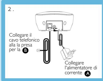
3. Collegare l'altro capo del cavo telefonico alla presa della linea telefonica e l'altro capo del cavo di alimentazione alla presa di corrente.
