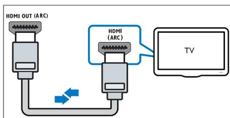
**1** Collegare il connettore **HDMI OUT (ARC)** sul sistema Home Theater al connettore **HDMI ARC** sul TV mediante un cavo HDMI ad alta velocità.
