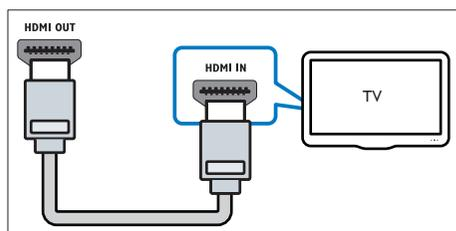
1 Collegare il connettore **HDMI OUT (ARC)** sul sistema Home Theater al connettore **HDMI** sul TV mediante un cavo HDMI ad alta velocità.
