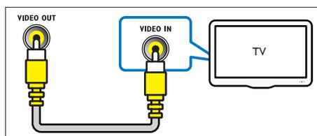
1 Collegare il connettore **VIDEO OUT** sul sistema Home Theater al connettore **VIDEO IN** sul TV mediante un cavo composite video.
