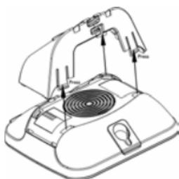
**1** Retire o suporte da parte de trás da estação de base pressionando para baixo os dois engates no topo do suporte.
