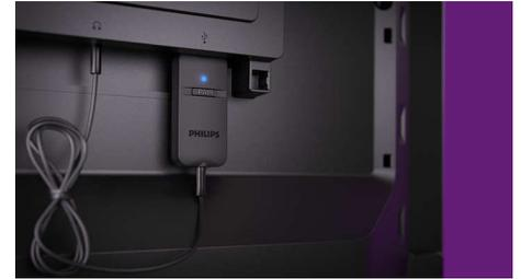
Basta inserire il cavo da 3,5 mm in dotazione nell'uscita per le cuffie del TV e collegare la chiave hardware all'altra estremità del cavo. Quindi non resta che inserire la chiave hardware nella presa USB del TV. Per il collegamento al PC, inserisci la chiave hardware nella presa USB ed esegui la configurazione audio.
