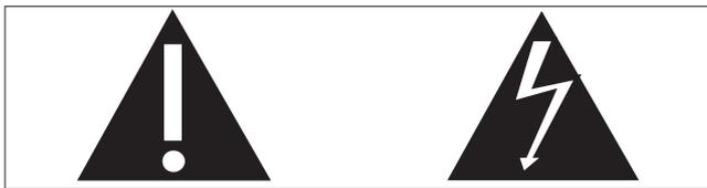
Dieser Blitz weist darauf hin, dass nicht isoliertes Material im Geräteinneren zu einem elektrischen Schlag führen kann. Entfernen Sie zur Sicherheit der im Haushalt lebenden Personen niemals das Gerätegehäuse.
