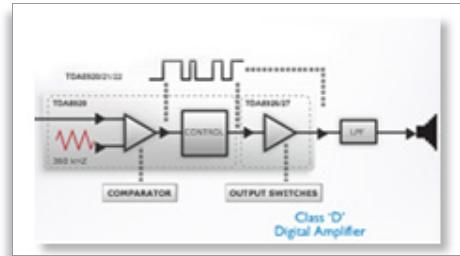
Class D 數碼放大器接收類比訊號，將其轉換為數碼訊號，然後以數碼方式加以放大。此訊號再進入解調濾波器，得到最後輸出。經放大後的數碼輸出訊號含有數碼音訊的全部優點，包括音質的改善。此外，與傳統 AB 放大器相比，D 級數碼放大器的效率超過 90% 以上。因此，可以在很小的地方放置此功能強大的放大器。
