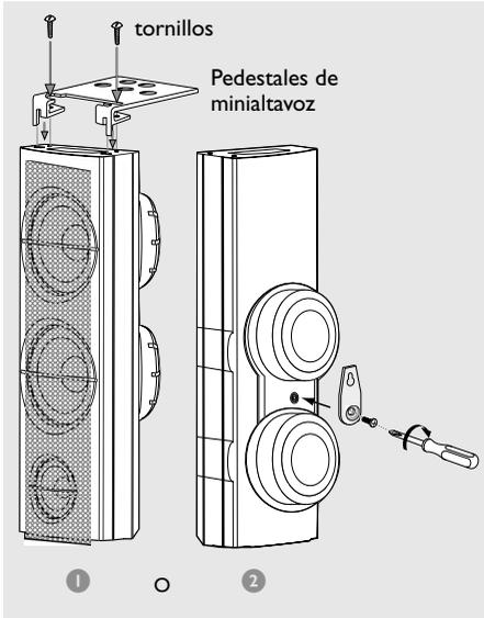
1 Antes de conectar los altavoces de sonido envolvente al sistema DVD, sujete firmemente los pedestales de minialtavoz a los altavoces de sonido envolvente utilizando los tornillos suministrados.
