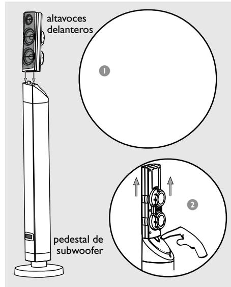
Las conexiones entre los altavoces delanteros y el sistema DVD se realizan a través del pedestal de subwoofer doble.
