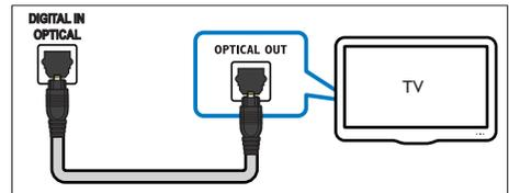
1 Mediante un cable óptico, conecte el conector **OPTICAL** del SoundBar al conector **OPTICAL OUT** del televisor o de otro dispositivo.
