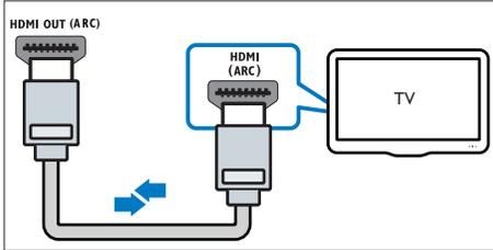
1 Mediante un cable HDMI de alta velocidad, conecte el conector **HDMI OUT (ARC)-TO TV** del SoundBar al conector **HDMI ARC** del televisor:
