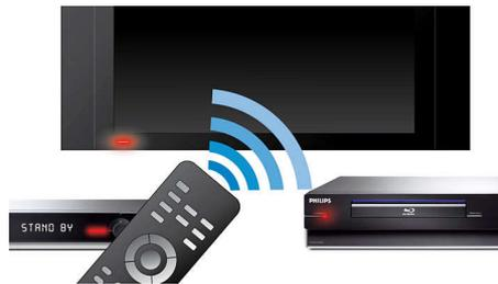
EasyLink vous permet de contrôler plusieurs appareils (lecteurs de DVD/Blu-ray, barres de son, home cinémas, téléviseurs, etc.) avec une seule télécommande. Le protocole standard HDMI CEC est utilisé pour mettre en commun les fonctionnalités de plusieurs appareils via un câble HDMI. D'une simple pression sur un bouton, vous pouvez contrôler simultanément tous les appareils connectés compatibles
