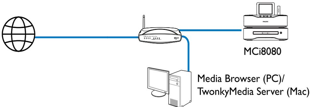
È possibile collegare **MCi8080** alla rete domestica Wi-Fi/cablata in diverse modalità: wireless o cablata, automatica o manuale.
