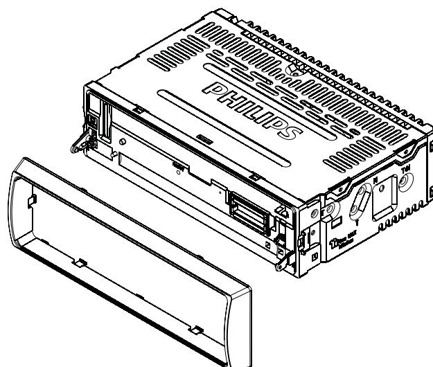
**2** 將面板左側插入底座中，直到正確接合。
